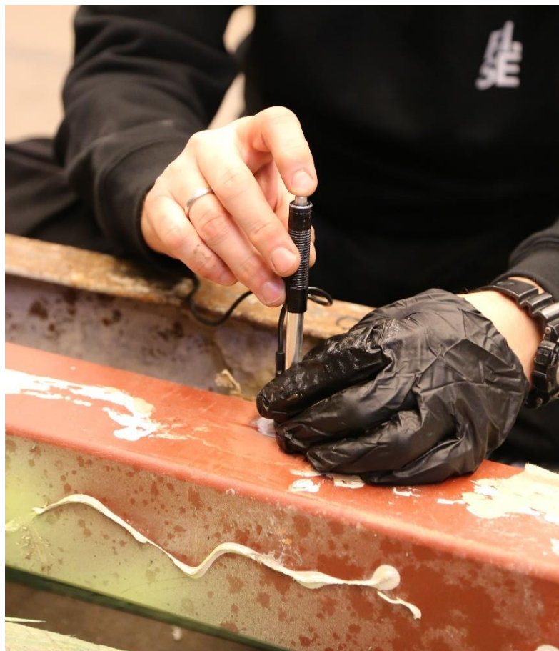
Figur 26 Hårdhetsmätning med portabel mätare.
