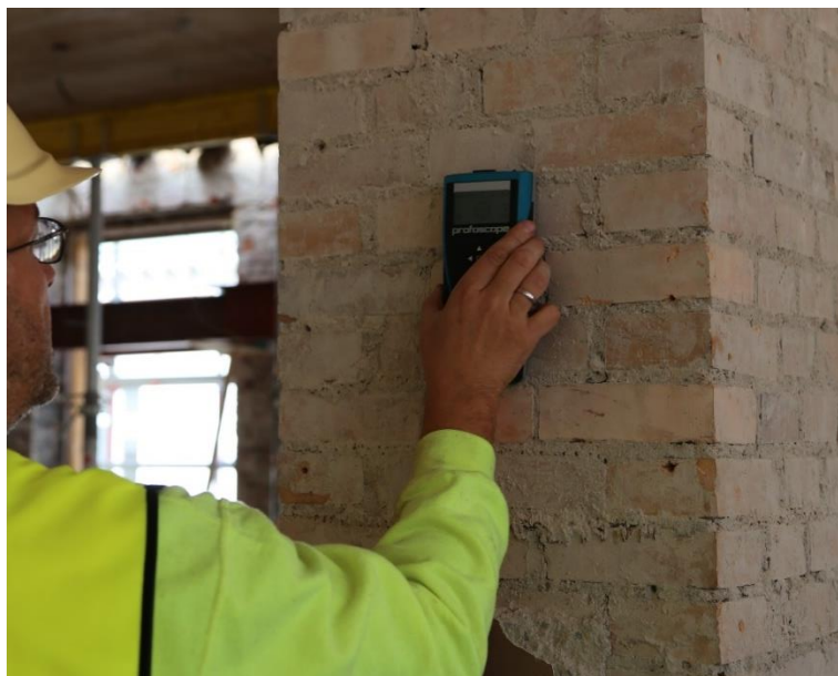
Figur 3 Undersökning av yt- och tätskikt fungerar lika bra på tegel som på betong. Foto: Ida Gabrielsson (RISE).
