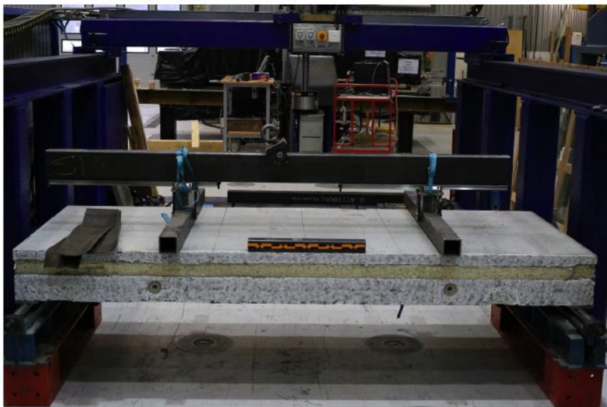
Figur 18 Provuppställning för provning av ett sandwich-elements böjhållfasthet (Foto: RISE). Elementet är 240 cm långt och vilar på två stöd i ändarna, medan lasten appliceras kontrollerat via de två balkarna på ovansidan (provningen är alltså fyrpunkts böjhållfasthetsprovning). Sandwich-elementet består underifrån och upp av en innerpanel i betong, isolering och slutligen en ytterpanel i betong. Sidorna på betongpanelerna har sprayats med specialfärg för att göra det lättare för det digitala töjningssystemet att hitta objekt att jämföra från foto till foto.
