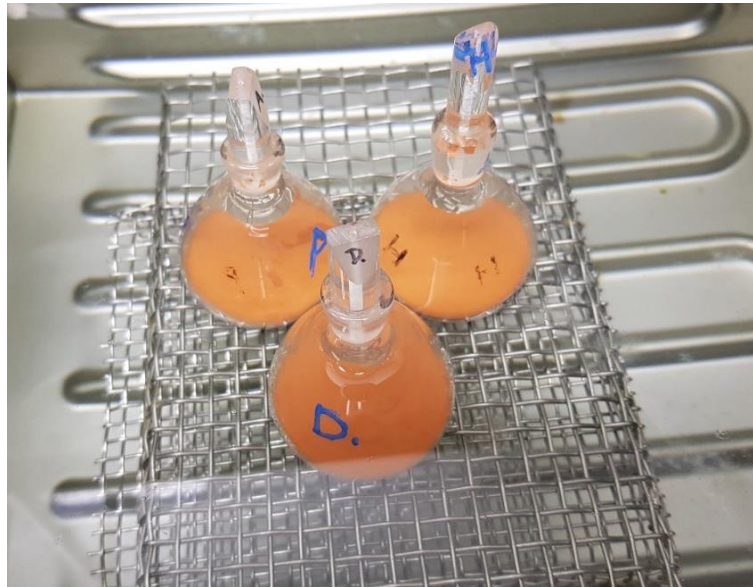
Figur 16 Prover för mätning av kompaktdensitet. Källa: RISE.
