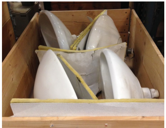
Bild 3. Lastning och emballering av tvättställ, blandare eller utslagsbackar på lastpall.
