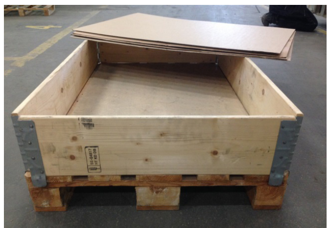
Bild 4. Använd pallkragar för att kunna stapla flera lager ovanpå varandra.
