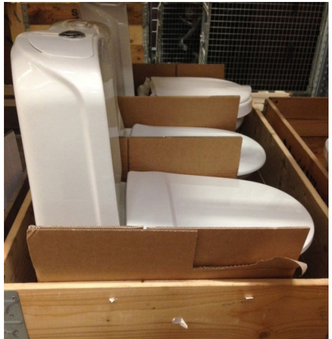
Bild 2. Lastning och emballering av toalettstolar på lastpall.
