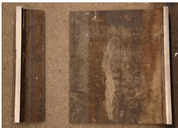
Figur 21 Exempel på uttag av provbit i livet på balk, för vidare provning av mekaniska egenskaper.
