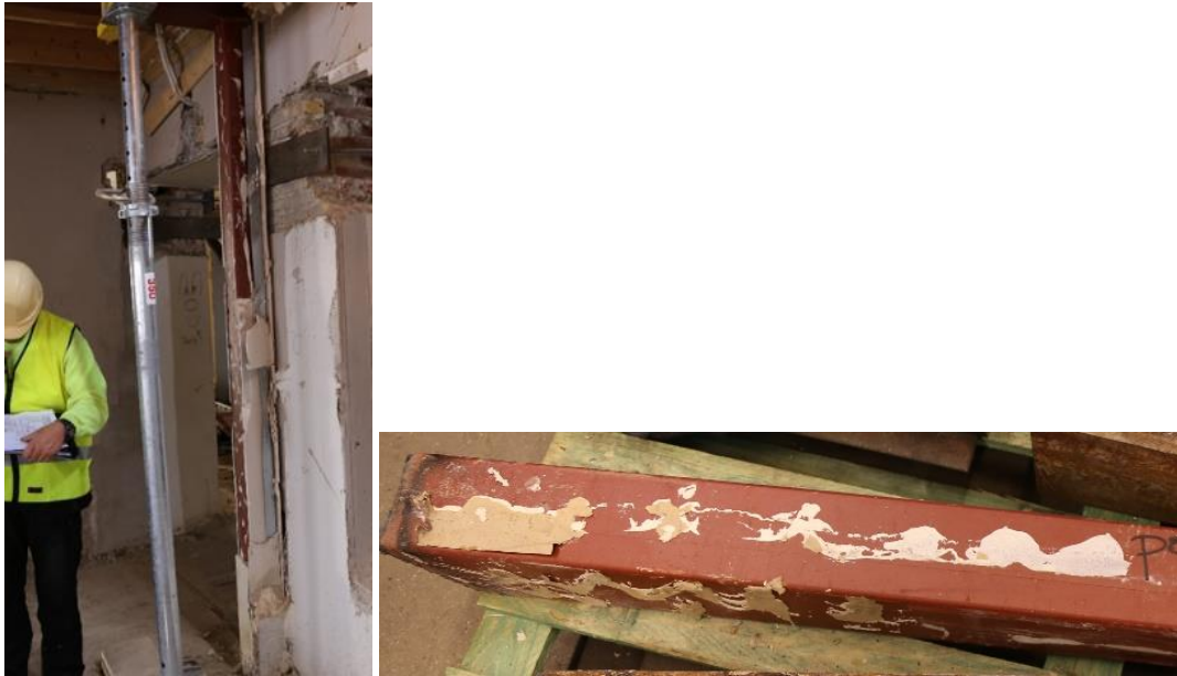
Figur 19 Pelare P28. Pelarens läge i byggnaden (t.v.) och den kapade sektionen som RISE hämtat till laboratoriet i Borås för analyser och provningar (t.h.). Sektionens mått: 95*95*1000 mm.
