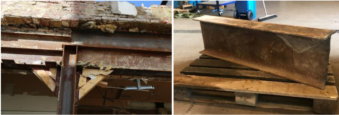
Figur 16 Balk B18. Balkens läge i byggnaden (t.v.) och den kapade sektion som RISE hämtat till laboratoriet i Borås för analyser och provningar (t.h.). Sektionens mått: 360*170*1250 mm.
