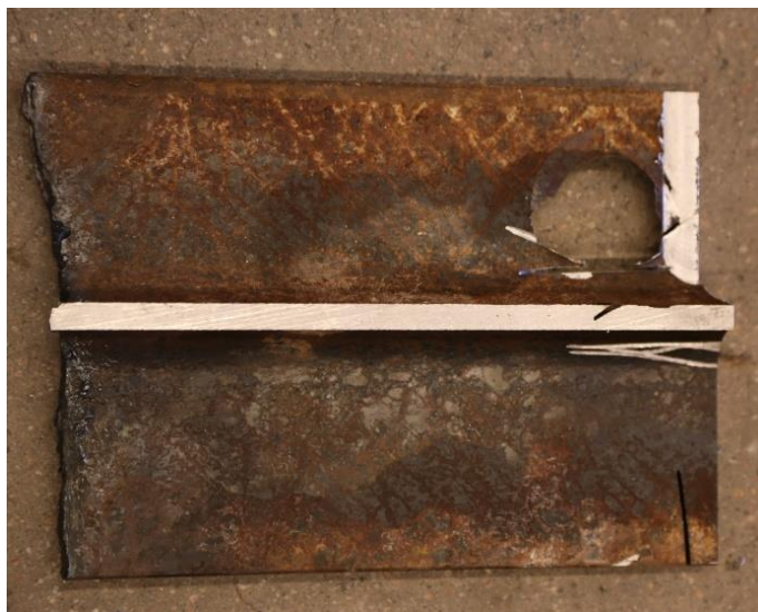
Figur 20 Exempel på uttag av provbit, "puck", ur balk, för analys av kemisk sammansättning.
