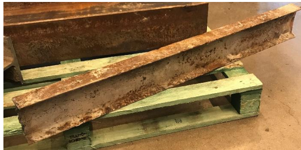
Figur 17 Balk B10 Foto på den kapade sektionen av stål balk som RISE hämtat till laboratoriet i Borås för analyser och provningar. Sektionens mått: 125*55*1000 mm.
